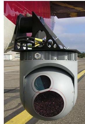
C'est un opérateur caméra qui dans l'avion propose un champ de vision ou pointe sur des objets particuliers. En infra rouge, il est possible de paramétrer l'étalage maximum des plages de températures et ainsi d'optimiser la distinction d'écarts importants. Les zones blanches mettent en valeur des surfaces chaudes.
